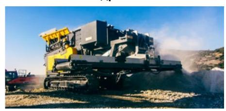
Молотковая дробилка предназначена для дробления камней и обломочных материалов в карьерах, на местах сноса и проведения земляных работ; находит применение также для подготовки постели каменной кладки и покрытий для газопроводов, водопроводов, маслопроводов
