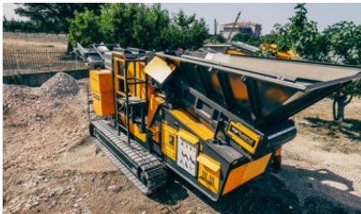
Щековая дробилка используется для дробления камней и обломочного материала, полученного от рытья и сноса, но в отличие от молотковой дробилки, имеет большое преимущество в измельчении сильно изнашивающих материалов (гранит, речной каменный материал и т.д.).
