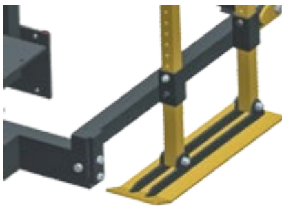
Slitte per regolazione profondità Skids for working depth adjustment
