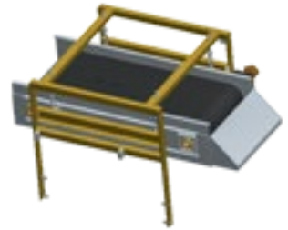
SEPARATORE MAGNETICO MAGNETIC SEPARATOR
